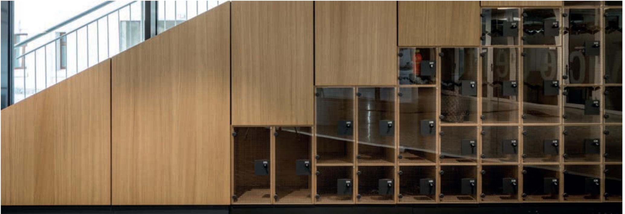
Die **proline** multiONE ist eine Akustikplatte, welche passgenau auf die Bedürfnisse von Weiterverarbeitern ausgelegt ist. Lochfreie Stege sorgen für eine optimale Aussteifung der Platte. Ein umlaufend lochfreier Rand bietet die Möglichkeit Beschlagsbohrungen für entsprechende Scharniere anzubringen. Damit ist die Platte im Maß 2.800 x 1.310 mm universell einsetzbar und ein idealer Wegbegleiter im hochwertigen Innenausbau.
