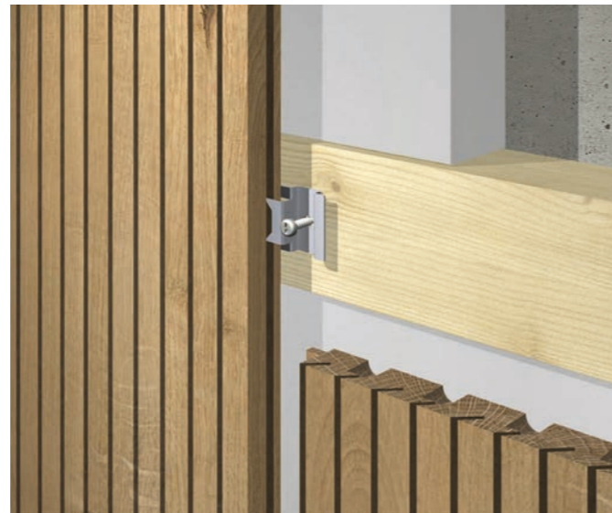
Detailansicht: vertikale Montage mit Montageclip
