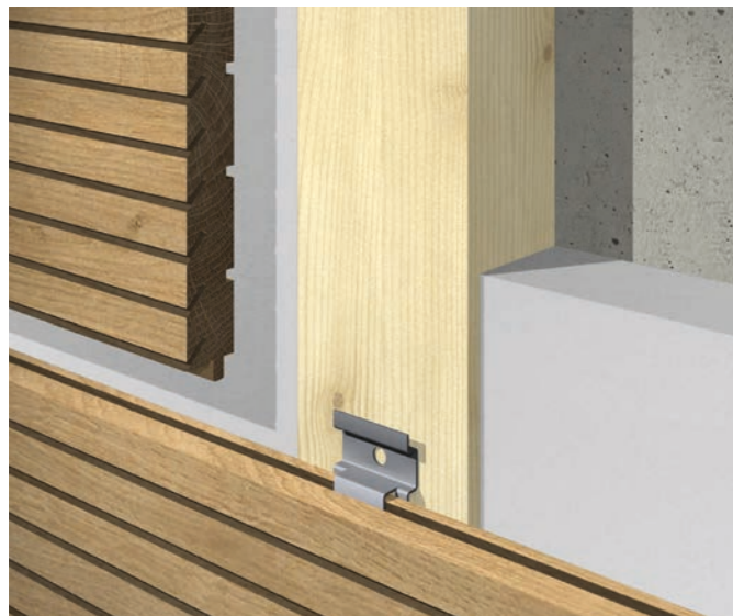
Detailansicht: horizontale Montage mit Montageclip
