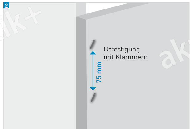
Klammern: mind. 7,5 mm, optimal: > 10 mm
